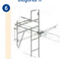
Amarração na laje, utilizando o suporte para fixação do aparalho ou parafuso que ultrapasse a espessura da laje
