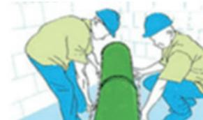
**2** Ahora ensamble el conjunto encajando la abertura de la base del conducto superior dentro de la abertura de la parte superior del conducto inferior.
