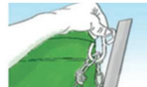
**5** Una vez que el conjunto esté en el exterior del edificio con la boquilla del conducto orientada hacia el interior, deben enganchar los mosquetes de la estructura del soporte a la cadena.
