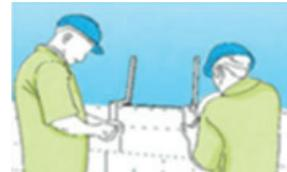
**1** En primer lugar, instale la estructura de soporte en el alero de una ventana. Recomendamos utilizar una tabla para distribuir las cargas de las clavijas de fijación.
