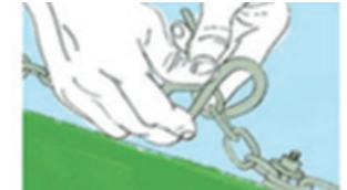
**3** Enganche los mosquetes de las cadenas de cada conducto en las argollas de la cadena del conducto de arriba, ajustándolos según la altura del suelo.
