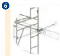
Atar a la losa, utilizando el soporte de fijación del aparato o un tornillo que supere el grosor de la losa.
